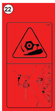
Abb. 25: Vor dem Betrieb die Haspelzinken sichern
