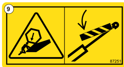
Abb. 12: Vor Arbeitsbeginn Haspelabsenksicherung aktivieren
