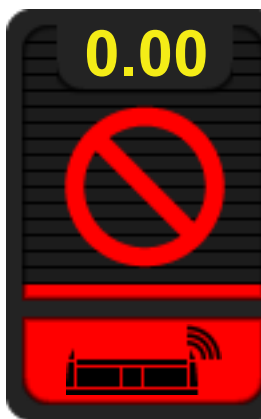
Abb. 126: Warnung! Schnitthöhensensor nicht erkannt!
