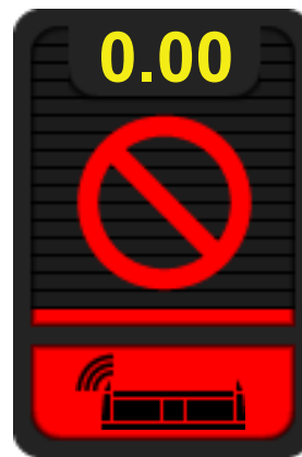
Abb. 126: Warnung! Schnitthöhensensor nicht erkannt!
