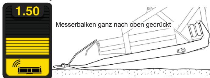
Abb. 119: Sensor-Balkenanzeige: Messerbalken ganz oben
