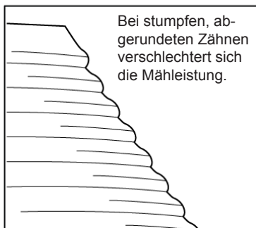
Abb. 211: Verschleiß an den Segmentmessern
