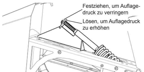
Abb. 225: Auflagedruckfeder des Halmteilers
